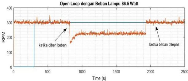
**GAMBAR 13** PERUBAHAN KECEPATAN AKIBAT PEMBEBANAN 86,5WATT
